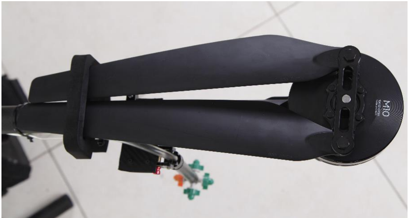
پهپاد سمپاش صبا بعد از انجام عملیات سمپاشی (در حالت بازوهای جمع شده)
